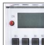
TSGE2 dioda sygnalizująca załączenie styku NC
