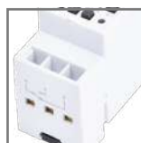
TSGE2 zaciski wyjściowe 1xNO i 1xNC (max 2x2,5mm 2 )
