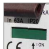
kontrolka sygnalizująca zadziałanie
