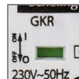
kontrolka sygnalizująca zadziałanie
