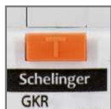
przycisk kontrolny TEST
