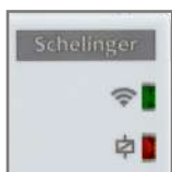
kontrolka sygnalizująca status połączenia
