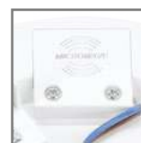
wbudowany czujnik mikrofalowy <2mW 5,8GHz
